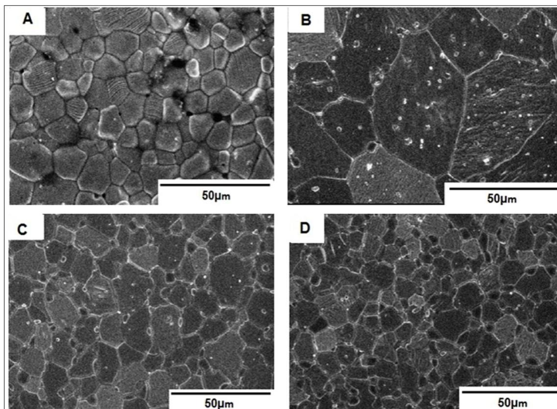
**Fig. 2** SEM images from the surface (a)0 %, (b) 0.5 %, (c) 1 %, and (d) 1.5 % Zr added samples.
