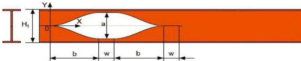
Fig 3: Sinusoidal void format with parameters
