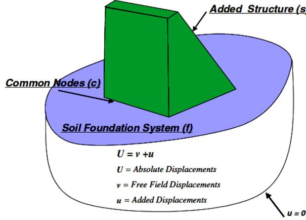
Fig ۲: Soil-Structure Interaction Model[۲].
